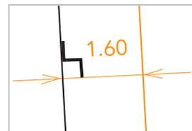
**b) par triangulation** prises par rapport à 2 points ou plus. Le réseau MPB (en orange) est coté par rapport à un point triangulation prises par rapport à 2 points: l'angle du mur et le centre de la plaque d'égout.
