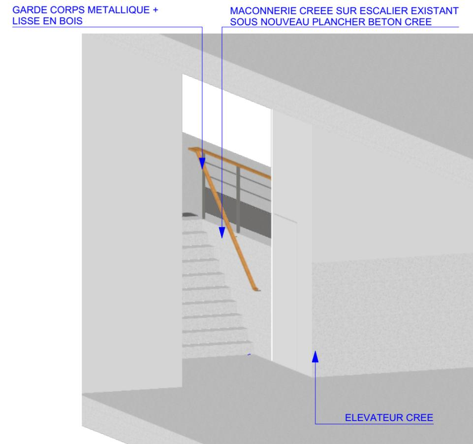
Vue coupée de l'élévateur et de l'escalier avec garde corps et main courante créés
